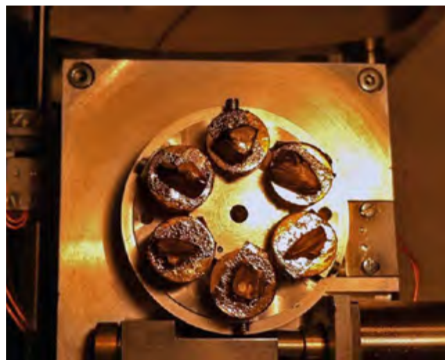
Рис. 1. Сколы зуба после напыления золота
